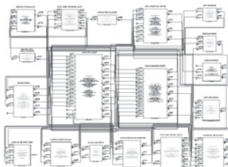
Obrázek 13: Implementace Guytonova modelu z roku 1972 v prostředí Matlab/Simulink, vyjádřená jako propojené simulační čipy. Každý ze simulačních čipů odpovídá jednomu z 18 propojených subsystémů.
